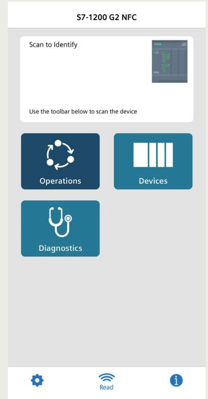
S7-1200 G2 能够通过为其定制的 NFC 应用程序，配合 CPU 内嵌入的 NFC 标签，利用近场通信技术来轻松访问 S7-1200 G2 系统。用户可在 Apple Store 中下载该应用程序“S7-1200 G2 NFC”。使用时，打开上述应用程序，将手机触碰 S7-1200 G2 CPU 的前面板，即可更改 CPU 的操作模式、查看连接到 CPU 的设备的详细信息以及读取诊断信息等。此 S7-1200 G2 NFC 应用程序将您的手机变成一个迷你人机界面（HMI）。此功能可在 TIA 博途中启用或禁用，并可根据数据安全方面需求，对用户权限进行相应的配置。
